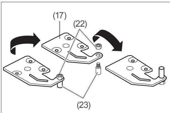
1. Lösen Sie mithilfe einer Zange die Mutter (22) am oberen Scharnier (17), schrauben Sie den Scharnierbolzen (23) des oberen Scharniers (17) heraus, und schrauben Sie ihn auf der anderen Seite der Scharnierplatte wieder hinein.
