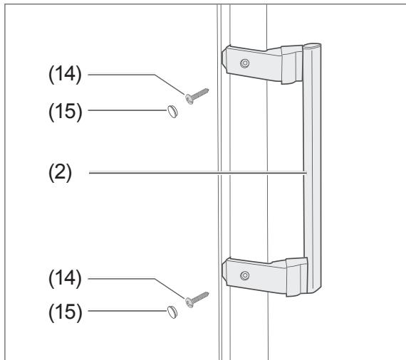
4. Befestigen Sie den Türgriff (2) mit den beiliegenden Schrauben (14) an der Tür.
