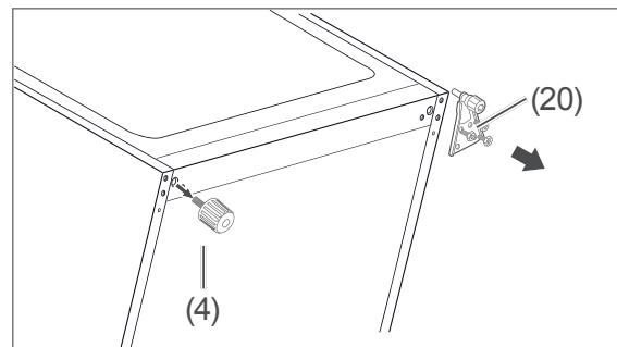
6. Kippen Sie das Gerät leicht nach hinten gegen eine Wand, sodass das untere Scharnier (20) zugänglich ist.
