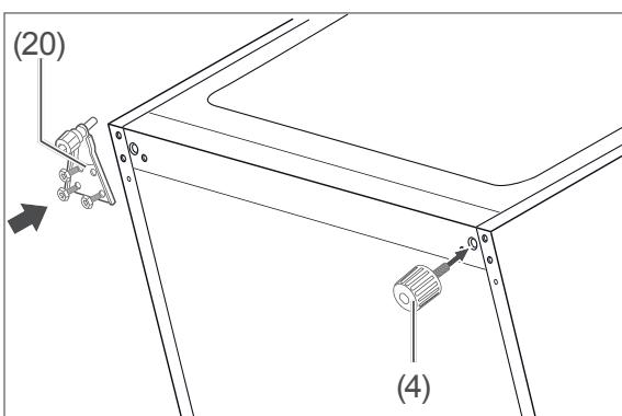
1. Setzen Sie das untere Scharnier (20) sowie den Schraubfuß (4) an der neuen Position wieder ein.
