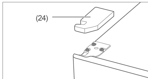
4. Setzen Sie die Schutzabdeckung (24) auf.
