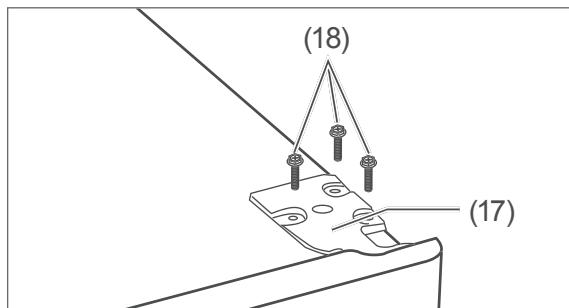
3. Schrauben Sie die 3 Schrauben (18) am oberen Scharnier (17) heraus, und entnehmen Sie das obere Scharnier (17).
