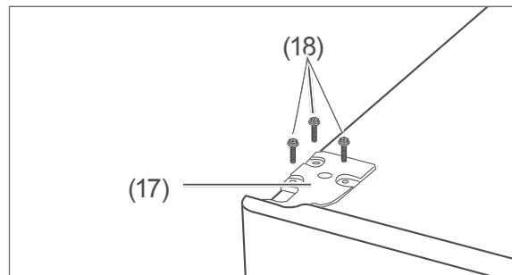
3. Setzen Sie das obere Scharnier (17) wieder ein, und schrauben Sie es mit den Schrauben (18) fest. Prüfen Sie, ob sich die Türen leichtgängig öffnen und schließen lassen.
