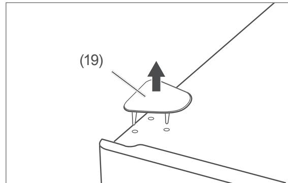
4. Heben Sie mit einem Schlitzschraubendreher die Abdeckung (19) auf der gegenüberliegenden Seite heraus.
