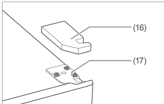
2. Heben Sie mithilfe eines Kreuzschlitzschraubendrehers die Schutzabdeckung (16) des oberen Scharniers (17) heraus.
