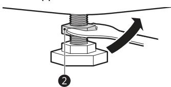
**4** Vérifiez que tous les écrous de blocage situés au bas de l'appareil sont correctement fixés.
