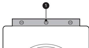
**3** Fixer les pieds de mise à niveau avec les écrous de blocage **②** en les tournant dans le sens contraire des aiguilles d'une montre contre le fond de l'appareil.
