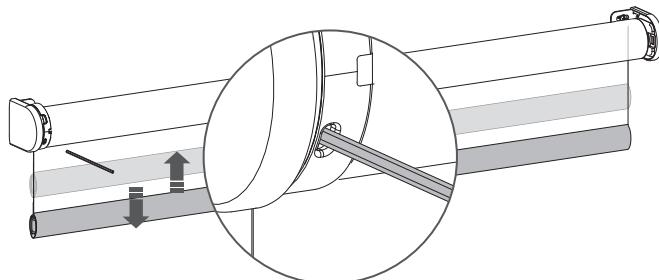
**17.1** Premere brevemente il pulsante **program** (programmazione) sul motore per attivare la modalità di programmazione.
