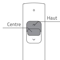
**9.1** Appuyez simultanément sur les boutons **centre** et **haut** jusqu'à ce que le store arrête de bouger et recommence à bouger.
