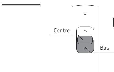
**11.1** Appuyez simultanément sur les boutons **centre** et **bas** jusqu'à ce que le store arrête de bouger et recommence à bouger.
