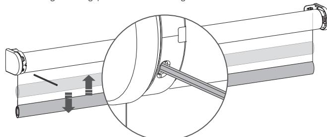
17.1 Drücken Sie kurz die **Programmtaste** am Motor, um den Programmierungsmodus zu aktivieren.
