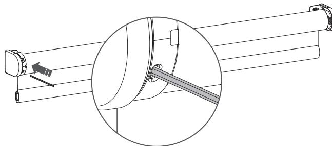
**6.1** Drücken Sie **mit** dem Stift am Motor kurz auf die Programmtaste. Die Fensterbekleidung beginnt, sich schrittweise in Bewegung zu setzen, was darauf hindeutet, dass der Programmierungsmodus aktiviert wurde. (Die Fensterbekleidung wird sich solange weiter bewegen, bis der Programmierungsmodus deaktiviert wird.)
