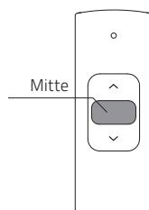
**Fernbedienung:** Drücken Sie die **Mitteltaste**, damit die Fensterbekleidung in die bevorzugte Position fährt.
