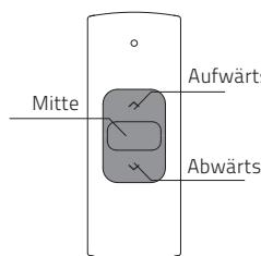
**Fernbedienung:** Drücken Sie die Taste „**Aufwärts**“ oder „**Abwärts**“, um die Fensterbekleidung zu bedienen.
