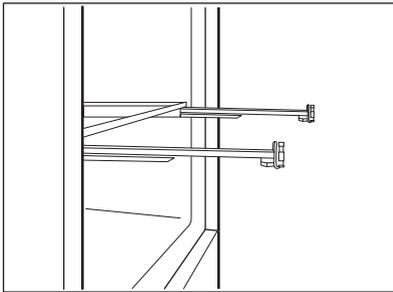
2. Setzen Sie den hinteren Teil der Schublade auf die Schienen.
