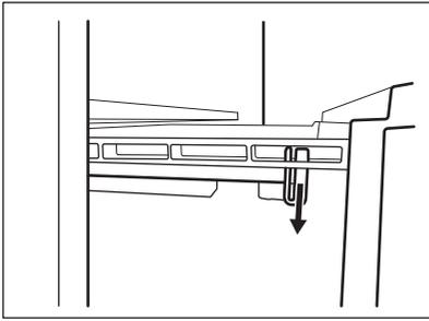
3. Ziehen Sie die Schublade heraus, während Sie sie nach oben heben, und lösen Sie sie von den Schienen.
