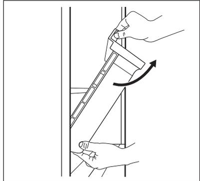
3. Heben und drehen Sie die Schublade, um sie aus dem Gerät zu ziehen.
