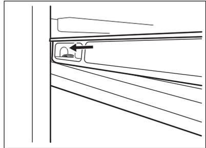
3. Heben Sie den vorderen Teil der Schublade an, während Sie sie hineinschieben.
