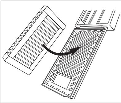
3. Halten Sie den Filter gedrückt, während Sie das Kunststoffgehäuse schließen, bis Sie ein Klicken hören.
