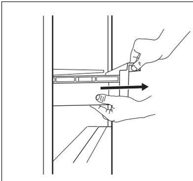
2. Heben Sie die Vorderseite der Schublade an.
