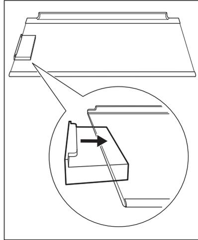
5. Setzen Sie die Glasablage wieder in den Kühlraum ein. Achten Sie darauf, dass Sie beim Einsetzen der Glasablage nicht gegen den Filter stoßen.
