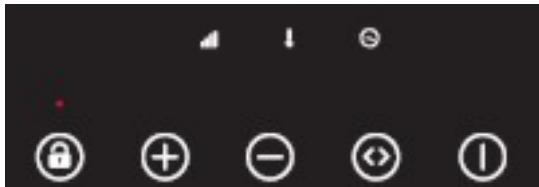
**Uw apparaat heeft een Touch Control display, alle functies worden alleen al door aanraking geactiveerd. The usage of both plates is identical.**
