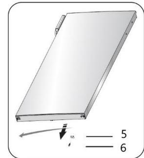
11. Stopper links einsetzen und festschrauben.
