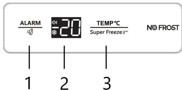
Bei Erstbetrieb den Temperaturregler auf „Super Freeze“ stellen. Nach ca. 6 Stunden hat das Gerät seine normale Betriebstemperatur erreicht und ist einsatzfähig. Die Temperatur auf eine mittlere Stufe zurückstellen.
