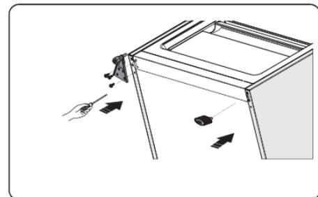
17. Gerätetür auf den Stift des unteren Scharniers setzen und vorsichtig schließen.
