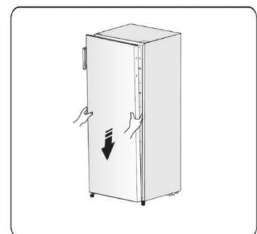
18. Stift des oberen Scharniers in das obere Türloch einsetzen.
