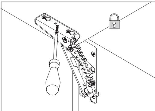
**Öffnungswinkel einstellen** / Adjusting opening angle / Régler angle d'ouverture /
