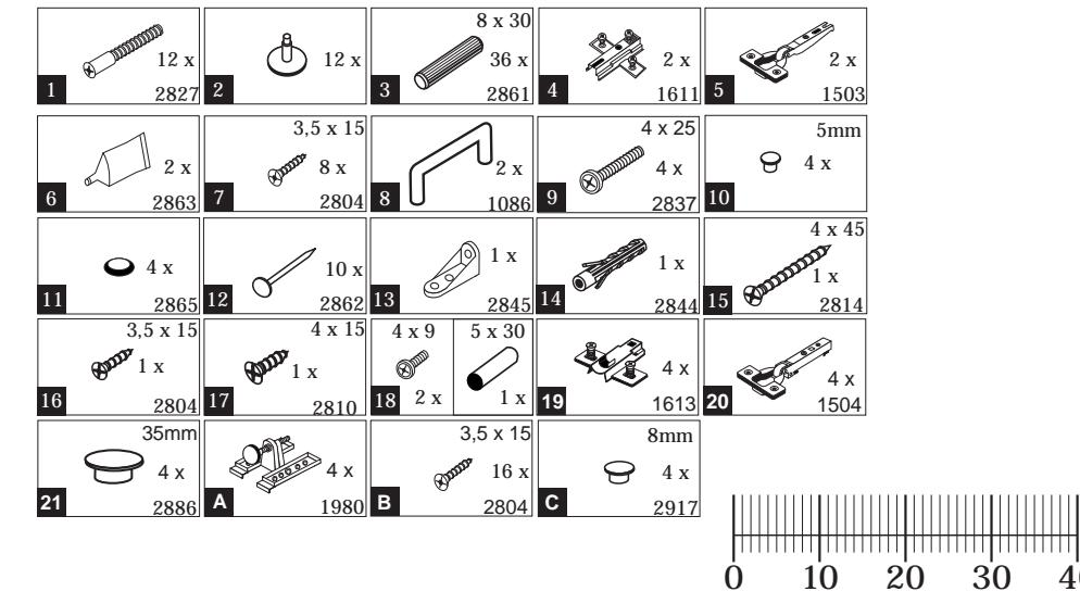
Das beigelegte Wandbefestigungsmaterial (Dübel und Schrauben) eignet sich nur für festes Mauerwerk (z.B.: Beton- oder Ziegelwände). Für andere Wandaufbauten sind eventuell Spezialdübel und andere Schrauben notwendig. Ziehen Sie gegebenenfalls eine Fachkraft zu Rate.
