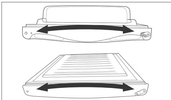
17. Schrauben Sie an der Oberseite der Kühlfachtür und an der Unterseite der Gefrierfachtür die Scharnierbuchsen ab und
