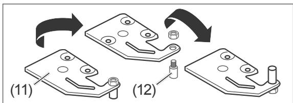
4. Schrauben Sie die Mutter mit einem 10er Schraubenschlüssel vom Scharnierbol-
