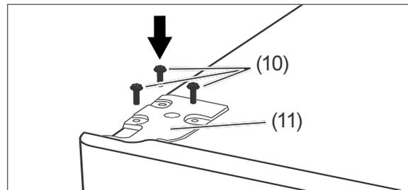
22. Stecken Sie die obere Scharnierplatte (11) auf die Kühlfachtür und schrauben Sie sie anschließend mit den drei Schrauben (10) fest.
