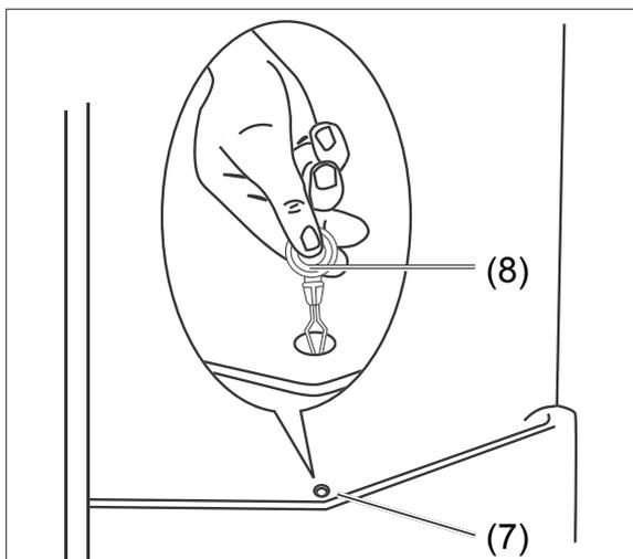
11. An der Rückwand des Kühlbereichs, oberhalb der Obst- und Gemüseschublade befindet sich der Tauwasserablauf (7). In der Öffnung des Tauwasserablaufs steckt das
