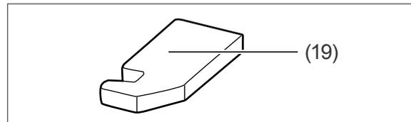
24. Pressen Sie die Scharnierblende (19) auf die Scharnierplatte und die Abdeckplatte in die Löcher auf der gegenüberliegenden Seite.
