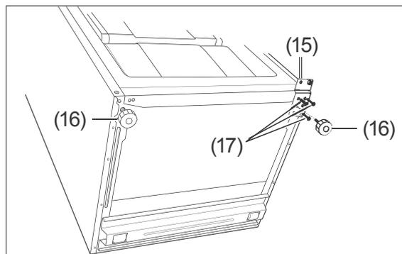
8. Kippen Sie das Gerät so weit nach hinten (45° max.), dass Sie die vorderen Gerätefüße (16) und die untere Scharnierplatte (15) gut erreichen können.
