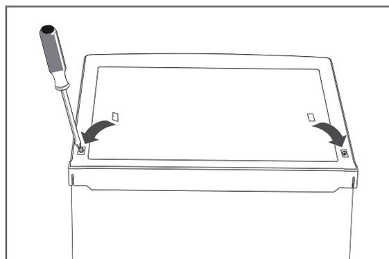
7. Legen Sie die Abdeckung wieder auf den Gefrierschrank zurück. Drücken Sie an beiden Seiten vorne links und rechts auf die Abdeckung, bis sie einrastet.
