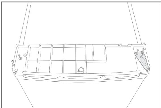
5. Drehen Sie die drei Befestigungsschrauben der Scharnierplatte und die einzelne Schraube auf der gegenüberliegenden Seite heraus. Verwenden Sie dafür einen 8er Schlüssel oder einen Kreuzschlitz-Schraubendreher. Nehmen Sie die Scharnierplatte ab.
