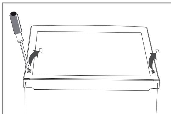
2. Lösen Sie die beiden Schraubabdeckungen auf der Oberseite der Abdeckung mit einem Schlitz-Schraubendreher.
