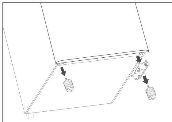
9. Kippen Sie den Gefrierschrank nach hinten (maximal 45 °), damit Sie auch das untere Türscharnier umsetzen können.
