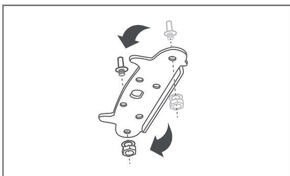
15. Drehen Sie die untere Scharnierplatte. Lösen Sie den Scharnierbolzen mit einem 10er Schlüssel. Lösen Sie die Muttern und setzen Sie die Muttern und den Scharnierbolzen von der anderen Seite aus wieder ein. Versetzen Sie die Schraube (4) auf die gegenüberliegende Seite.
