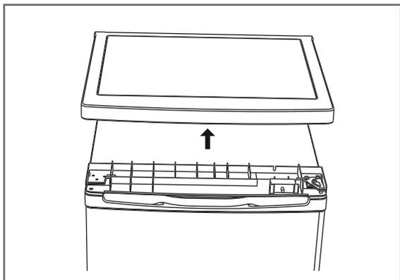
4. Hebeln Sie die beiden Seiten der Abdeckung vorne leicht nach außen und heben Sie die Abdeckung nach vorne ab. Achten Sie dabei darauf, den Temperaturregler (1) nicht zu beschädigen.
