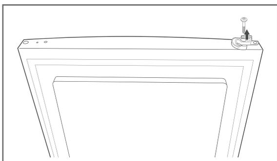
13. Entfernen Sie den Kunststoff-Einsatz von der Unterseite der Tür.
