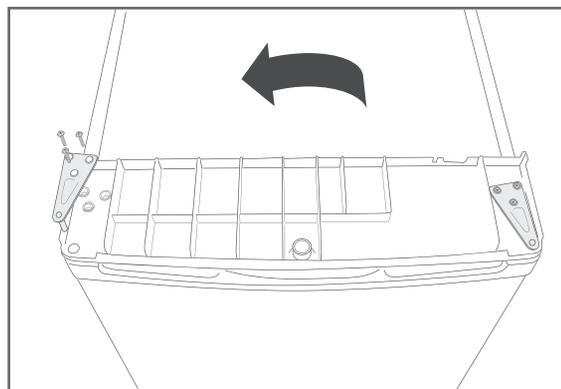
6. Schrauben Sie die Scharnierplatte sowie die einzelne Schraube auf der jeweils gegenüberliegenden Seite wieder an.
