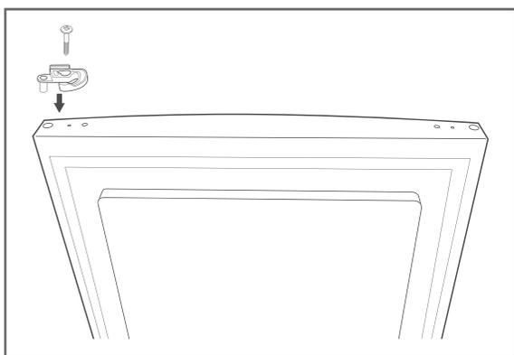
14. Setzen Sie den losen mitgelieferten Kunststoff-Einsatz auf der neuen Anschlagseite ein und schrauben Sie ihn fest.
