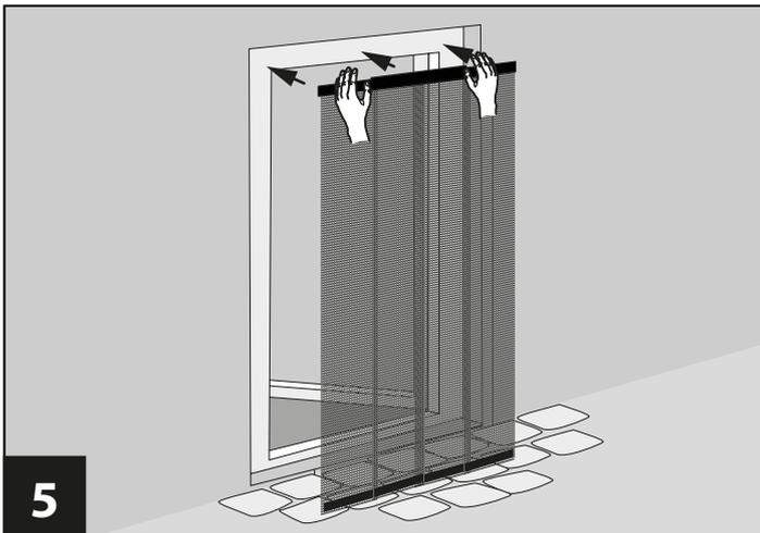
**5** Schutzfolie von Klebeband abziehen und fertigen Insektenschutz anbringen.
