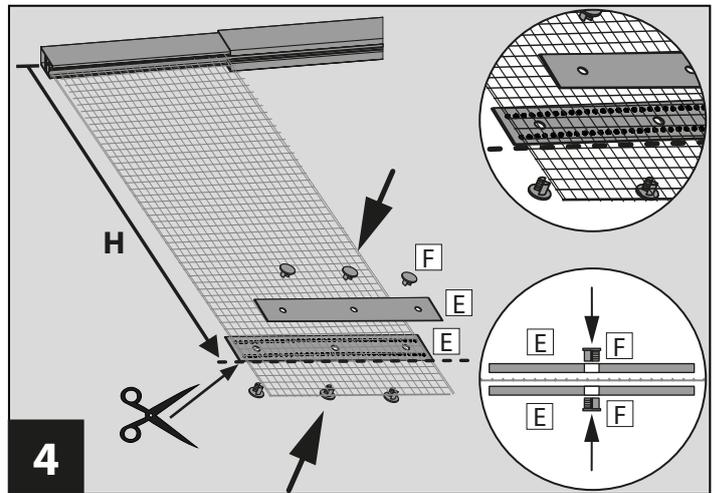
**4** Je Lamelle zwei Gewichte mit 6 Pins anbringen. Dabei wird die Lamelle zwischen zwei Gewichten eingeklemmt.
