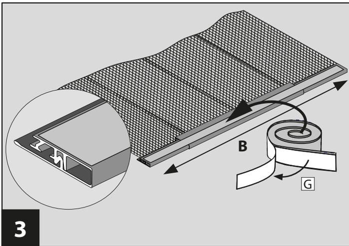
**3** Klebeband auf der Rückseite des Profils aufkleben.
