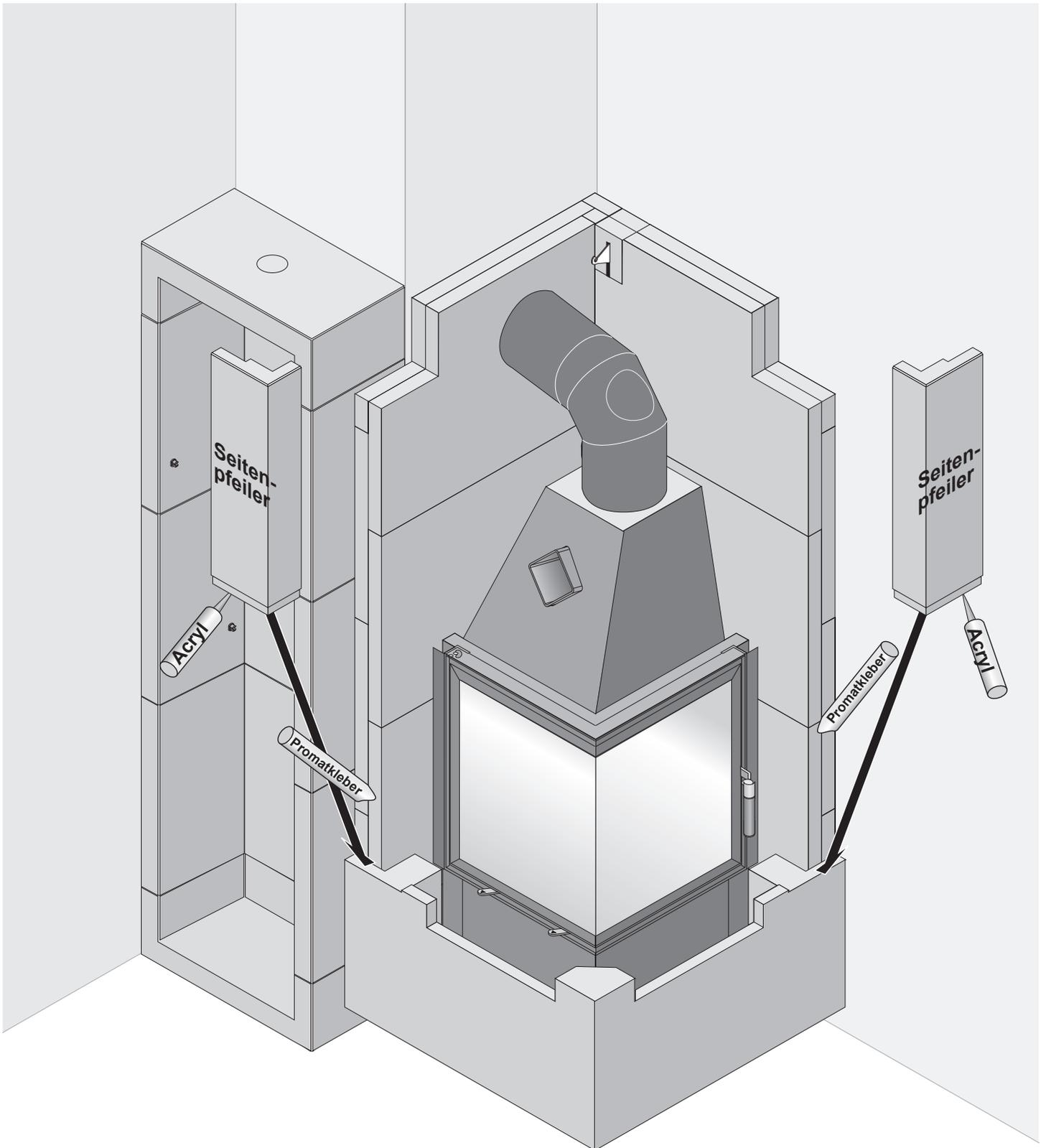
Kleben Sie die Seitenpfeiler mit Acrylkleber auf den Sockel und mit Promatkleber an die entsprechenden Stirnseiten der Isolierplatten. Die Wandanschlüsse (auch zum Regal) werden mit Acrylkleber verklebt.
