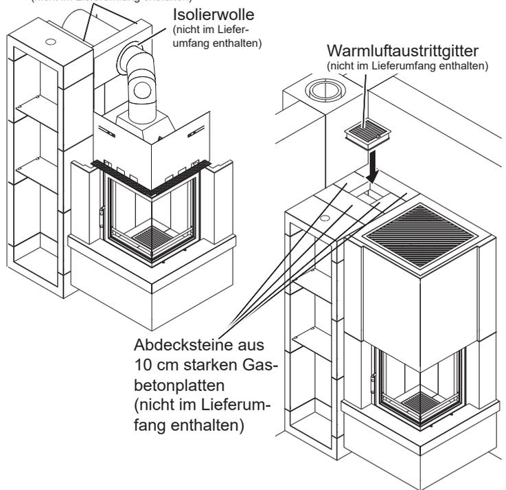
Abdecksteine aus 10 cm starken Gasbetonplatten
