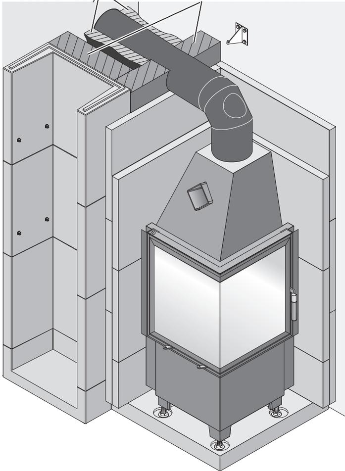
Ist kein Schornstein hinter dem Regal vorhanden oder ist der Schornstein schmaler als das Regal, muss eine Hintermauerung von 10 cm starken Gasbetonsteinen (nicht im Lieferumfang enthalten) hinter den Isolierplatten und dem Regal eingebracht werden.
