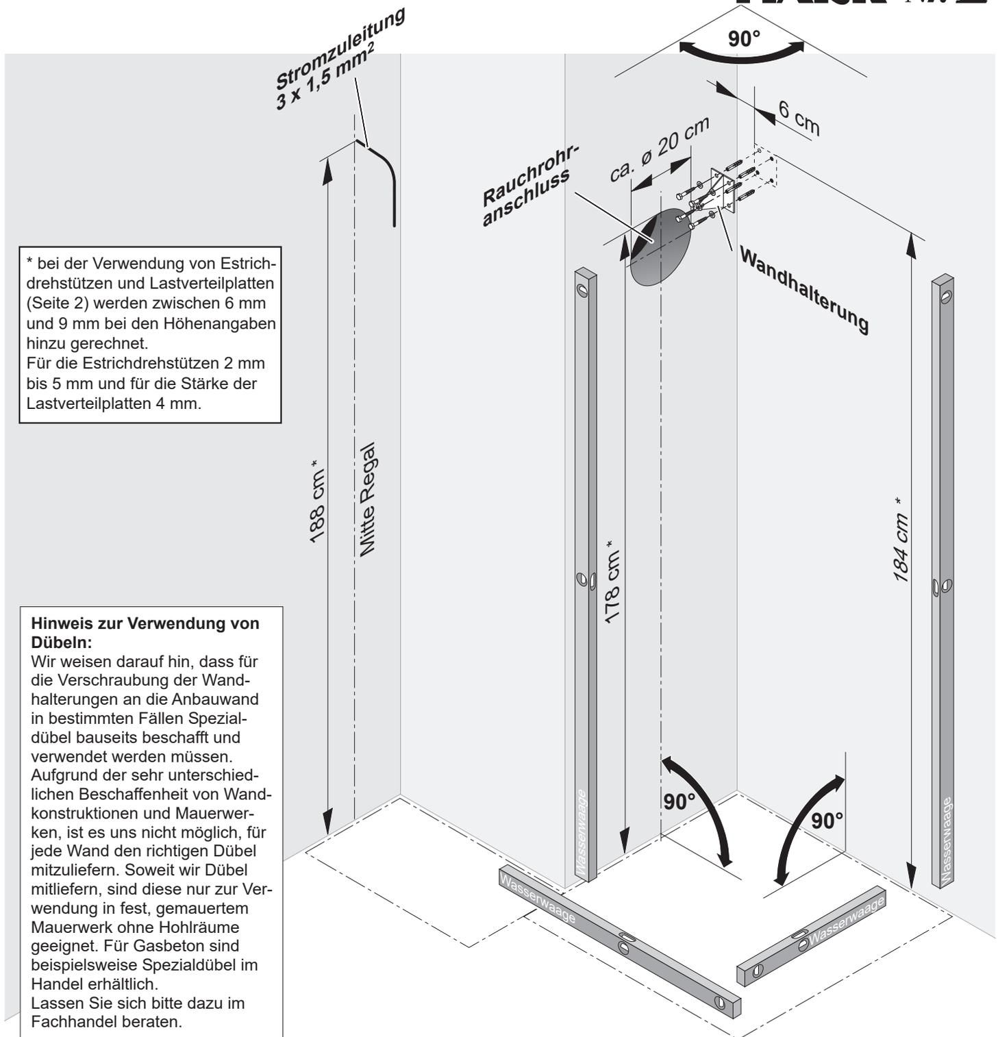
In dieser Montageanleitung ist die Montage des Easy 500 mit dem optional erhältlichen Regal beschrieben. Ohne Regal erfolgt der Aufbau des Kamins direkt an den beiden Stellwänden. Die Integration eines Schornsteins ist dann nicht möglich.
