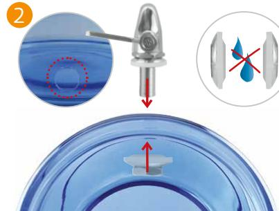
Montare il rubinetto con due guarnizioni (asciutte) all'interno ed all'esterno sul contenitore.
