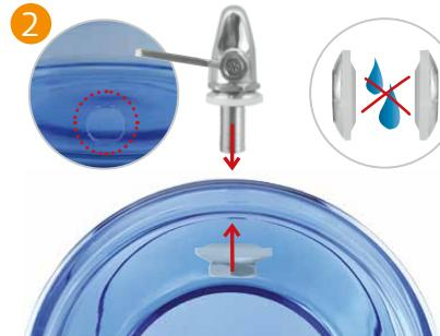
Montez le robinet d'eau avec deux joints (secs) à l'intérieur et à l'extérieur du réservoir.
