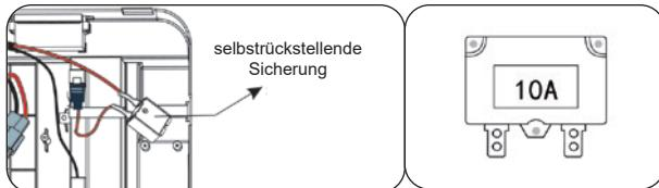
Das Fahrzeug ist mit einer selbstrückstellenden Sicherung ausgestattet. Wenn das Fahrzeug überlastet oder falsch benutzt wird, schaltet die selbstrückstellende Sicherung für ca. 5 - 10 Sek. ab, bevor sie wieder in Einsatz geht. Die selbstrückstellende Sicherung ist unter dem Sitz.
