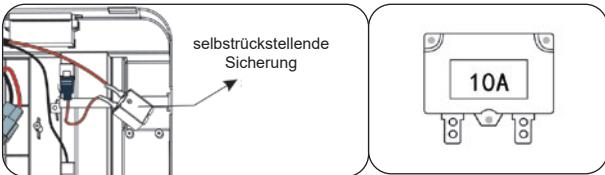
Model je vybaven přepěťovou ochranou. Pokud je model přetížen, přepěťová ochrana jej automaticky vypne a resetuje se během 5 - 10 sekund. Pojistka je pod sedadlem. Abyste se vyhnuly vypnutí modelu dodržujte tyto zásady:
