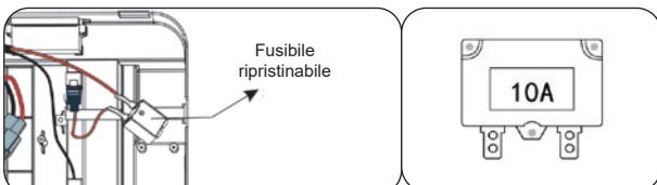
Il veicolo è dotato di un fusibile ripristinabile. Quando il veicolo sovraccaricato o viene utilizzato in modo non corretto, si spegne il fusibile per ca. 5 - 10 secondi prima che va di nuovo in azione. Il fusibile si trova sotto il sedile
