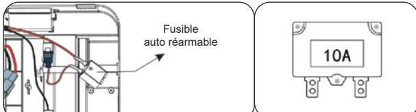
La voiture est équipée d'un fusible auto réarmable. Si celle-ci est surchargée ou mal utilisée le fusible de sécurité va sauter et interrompre la possibilité d'utilisation pour une durée entre 5 et 10 secondes, ensuite celui-ci s'arrêtera à nouveau et vous pourrez utiliser votre voiture. Ce fusible se trouve sous le siège
