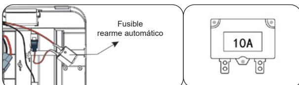
El vehículo está equipado con un fusible rearme automático. Cuando el vehículo está sobre cargado o se usa incorrectamente, se apaga el fusible de rearme automático durante unos 5 - 10 segundos, antes de que se usa. El fusible rearmable se encuentra bajo del asiento
