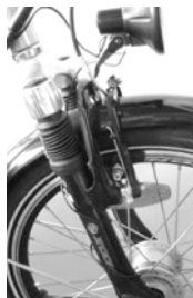
Fourche à suspension avec élastomère / amortissement
