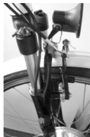
Einstellbare Federgabel mit Lock-Out (Sperre) und Justiermöglichkeit
