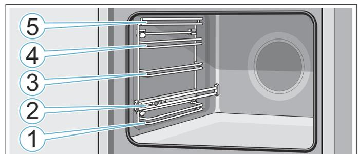
In den Einschubhöhen 1, 3, 4 und 5 das Zubehör immer zwischen die beiden Führungsstäbe einer Einschubhöhe schieben.
