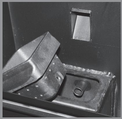
Abb. 6a: Brenntopf einsetzen
