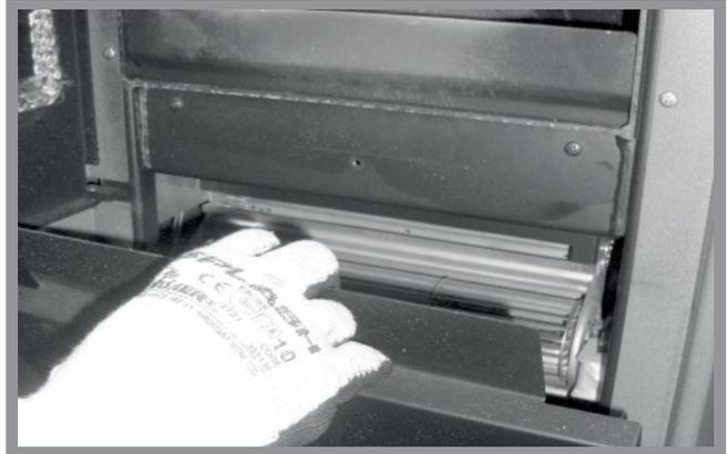
2. Entfernen Sie alle Schrauben (2 bzw. 4x) der Abdeckplatte mit einem Schraubenschlüssel (4 mm) wie in Abbildung 13b dargestellt.
