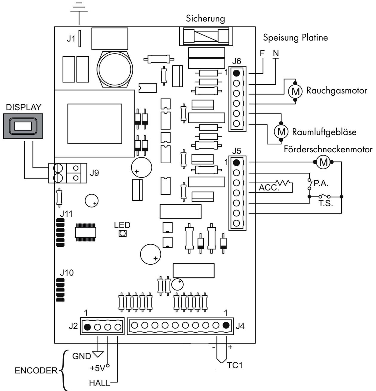
Abb. 15: Schaltplan der Platine
