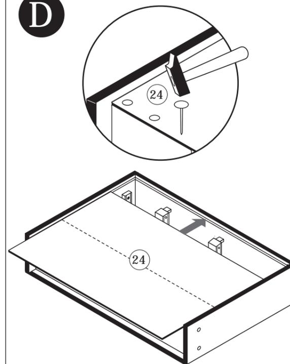
Bitte zeichnen Sie die Position des Konstruktionsbodens auf der Rückwand genau an, bevor Sie diese mit den Rückwandnägeln befestigen.
