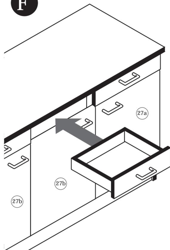
Die Metallauflisten ganz ausziehen, den Schubkasten dazwischen schieben und mit der Schraube links und rechts fixieren.
