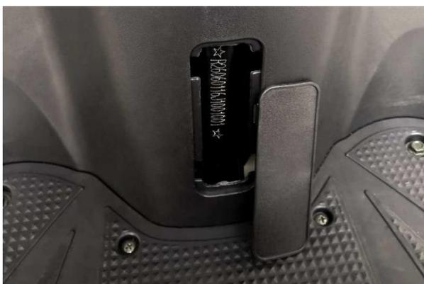
Die Fahrgestellnummer finden Sie an der vorderen Konsole über der Trittläche
