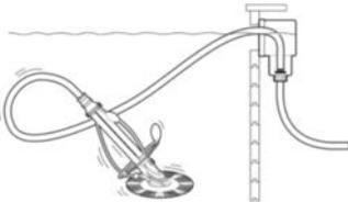
Het zuigen van de bodem (bijv. met Ubbink PoolCleaner Auto, art.nr. 7500401) vindt plaats in de stand FILTEREN (op de meerwegklep). De bodemzuiger moet met de bodemzuigerslang worden aangesloten op de skimmer. De pomp van de filterinstallatie moet uitgeschakeld zijn.
