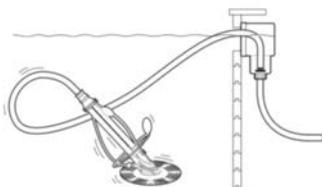
L'aspirazione del fondo (ad es. con Ubbink PoolCleaner Auto, cod. prod. 7500401) viene eseguita nella posizione **FILTRAZIONE** (sulla valvola a più vie). L'aspiratore deve essere collegato con il tubo flessibile dell'aspiratore allo sfioratore. La pompa del gruppo di filtrazione deve essere spenta.
