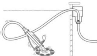
L'aspiration du fond (par ex. avec Ubbink PoolCleaner Auto, réf. 7500401) s'effectue dans la position FILTRATION (au niveau de la vanne à voies multiples). L'aspirateur de fond doit être raccordé au skimmer avec son tuyau. La pompe du groupe de filtration doit être arrêtée.
