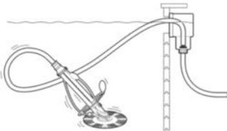
Das Bodensaugen (z.B. mit Ubbink PoolCleaner Auto, Art.-Nr. 7500401) erfolgt in der Position FILTERN (am Mehrweg-Ventil). Der Bodensauger ist mit dem Bodensaugerschlauch am Skimmer anzuschließen. Die Pumpe der Filteranlage muss ausgeschaltet sein.
