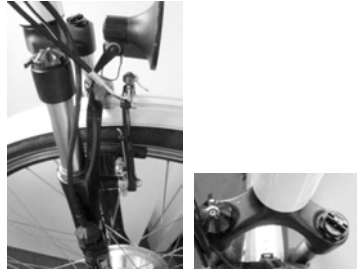
Instelbare veervork met lock-out (grendel) en bijstelbaarheid
