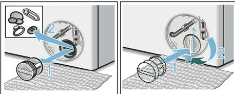
6. Service-Klappe einsetzen, einrasten und schließen.
