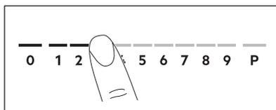
1. Drücken Sie die gewünschte Kochstufe auf der Einstellskala. Die Anzeigen oberhalb der Bedienleiste erscheinen bis zur gewählten Heizstufe.
