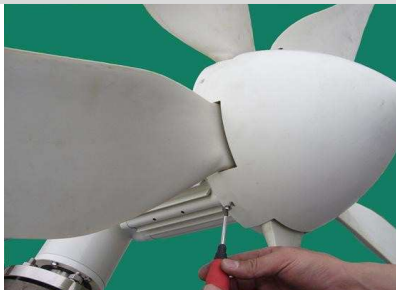
Schnappe die Abdeckkappe auf die Nabenscheibe und ziehe die Schrauben mit 7Nm an.
