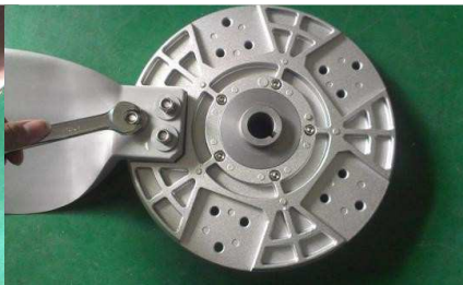
Setze erst Flügel und dann Unterlagscheibe auf und schraube selbstsichernde Mutter mit 18 Nm an
