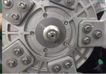
Ziehe die Mutter mit 290 Nm (Stormy Wings 1500) bzw. 500Nm (Stormy Wings 3000) an.
