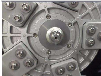
Führe den Sicherungssplint ein und biege die Enden um
