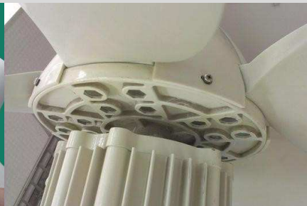
Prüfe ob die Abdeckklappe fest montiert ist. Drehe die Rotorblätter um zu prüfen ob eine reibungsfreie Rotation vorliegt.
