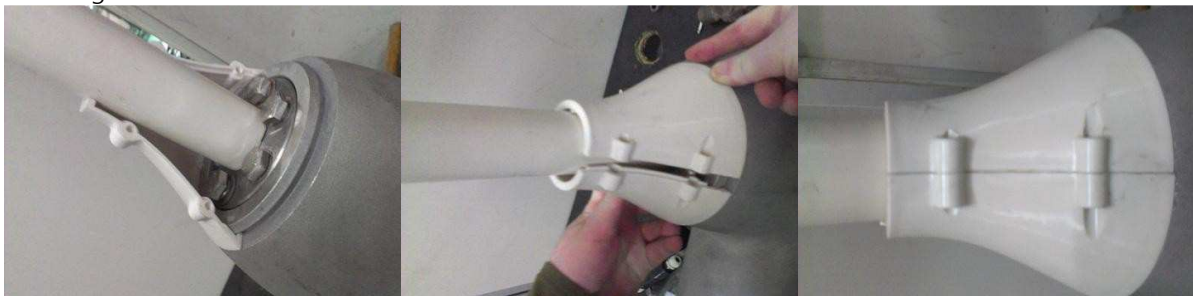
Schiebe die Abdeckungen auf den Verbindungsflansch
