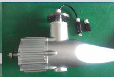
Schraube die Kappe der Anschlussklemme ab
