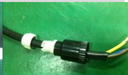
Führe das Kabel durch die Kappe
