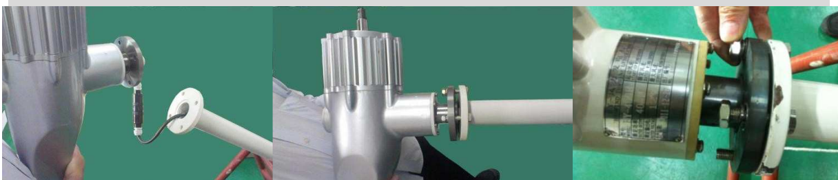
Schiebe das Kabel durch den Mast
