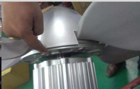
Schnappe die Abdeckkappe auf die Nabenscheibe. Stelle sicher, dass alle 5 Enden auf die Nabenscheibe aufgeschnappt sind. Prüfe den sicheren Halt und überzeuge dich, dass die Abdeckkappe nirgends schleift.
