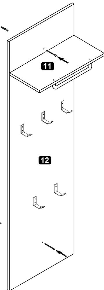
**D** Das beigeigefügte Wandbefestigungsmaterial (Dübel und Schrauben) eignet sich nur für festes Mauerwerk (z.B. Beton- oder Ziegelwände). Für andere Wandaufbauten sind eventuell Spezialdübel und andere Schrauben notwendig. Ziehen Sie gegebenenfalls eine Fachkraft zurate.
