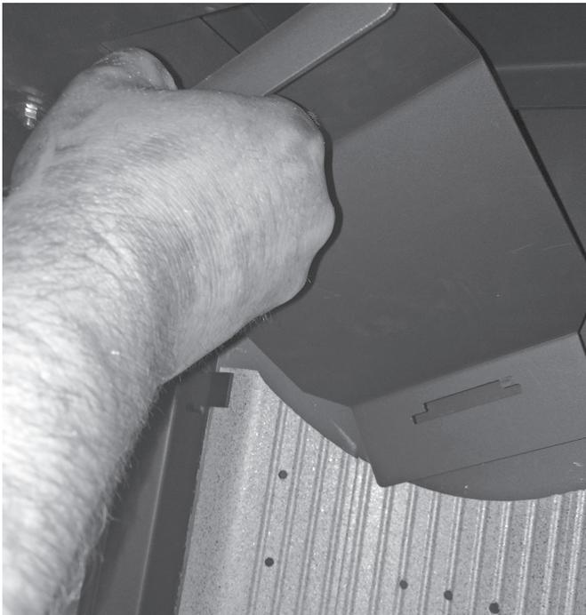
► Die 3. Stahlumlenkung ist wie die 1. Stahlumlenkung befestigt. Die Demontage erfolgt entsprechend.
