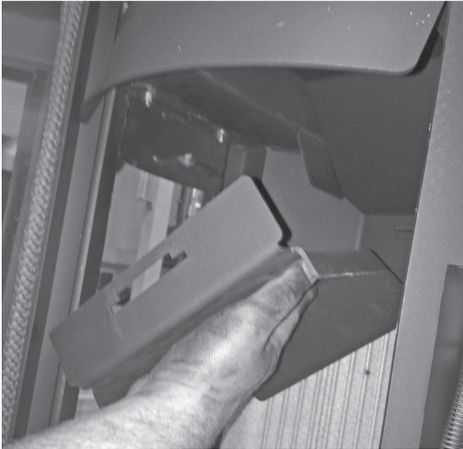
► Die 2. Stahlumlenkung ist hinten eingehängt. Die Stahlumlenkung leicht nach oben schieben und anschließend nach vorne aus der Bajonethalterung ziehen.
