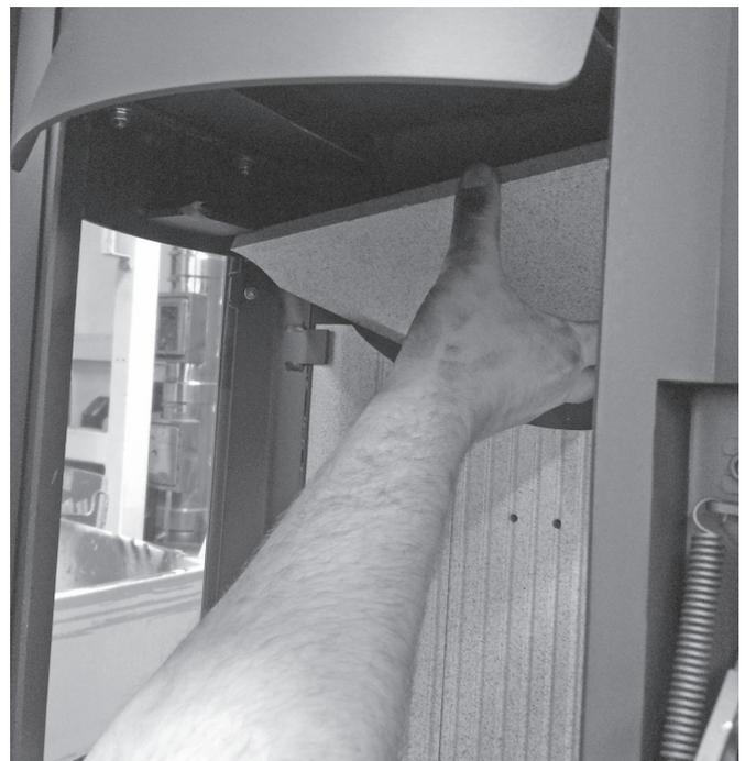
► Die 1. Stahlumlenkung ist in Richtung der Gerätefront eingehangen. Stahlumlenkung leicht nach oben schieben und anschließend nach hinten aus der Bajonethalterung ziehen..
