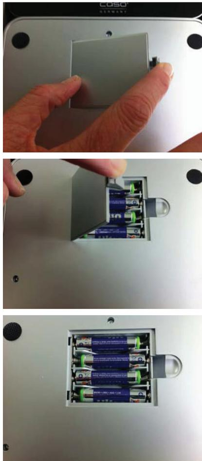
Plaats de 4 AAA batterijen zoals in het batterijvakje is aangegeven. Ten slotte plaatst u de batterijafdekking weer terug.
