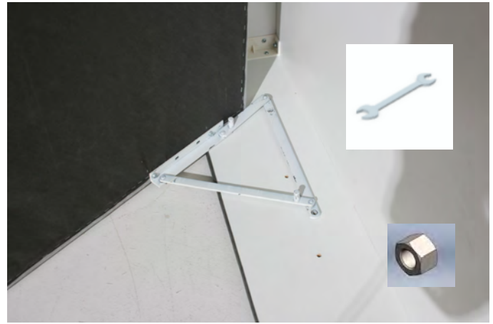
b) Liegefläche mit den Muttern am Beschlag festschrauben
