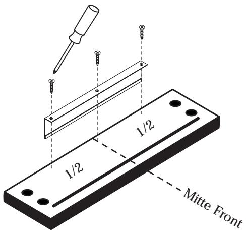
Montieren Sie die Griffleiste
