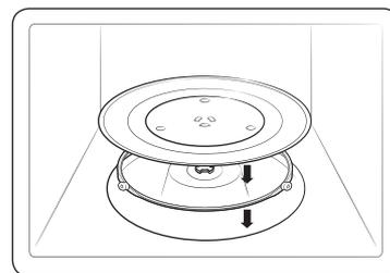
Entnehmen Sie das Verpackungsmaterial aus dem Inneren des Geräts. Setzen Sie den Drehring und den Drehteller ein. Vergewissern Sie sich, dass der Drehteller problemlos gedreht werden kann.
