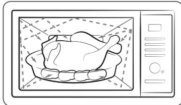
1. Die vom Magnetron erzeugten Mikrowellen werden im Innern des Garraums reflektiert und gleichmäßig verteilt, während sich die Speisen auf dem Drehteller drehen. So werden die Lebensmittel gleichmäßig erhitzt.
