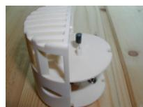
5. Platine in eine Gehäusehälfte einlegen. Einkerbung in der Führerplatte beachten.
