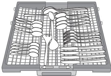
Die dritte Schublade wurde für das Hineinlegen von Besteck entwickelt. Platzieren Sie das Besteck wie abgebildet. Eine getrennte Anordnung des Bestecks macht das Sortieren nach dem Spülen einfacher und verbessert die Spül- und Trockenleistung.
