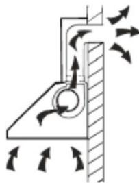
Die Abluft wird in einen Luftschacht oder nach außen geführt.
