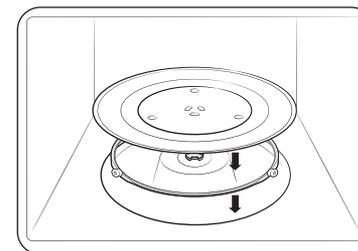
Entnehmen Sie das Verpackungsmaterial aus dem Inneren des Mikrowellengeräts. Setzen Sie den Drehring und den Drehteller ein. Vergewissern Sie sich, dass der Drehteller problemlos gedreht werden kann.
