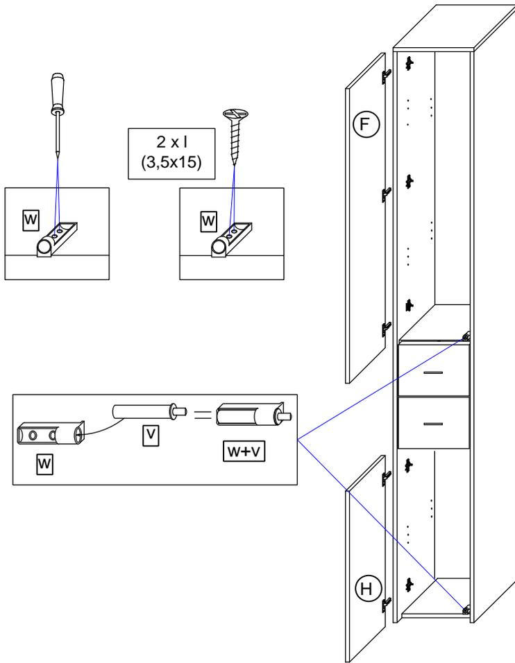
**T11** Bei Türmontage das Scharnier einhängen, bis Anschlag öffnen und anschließend festschrauben.
