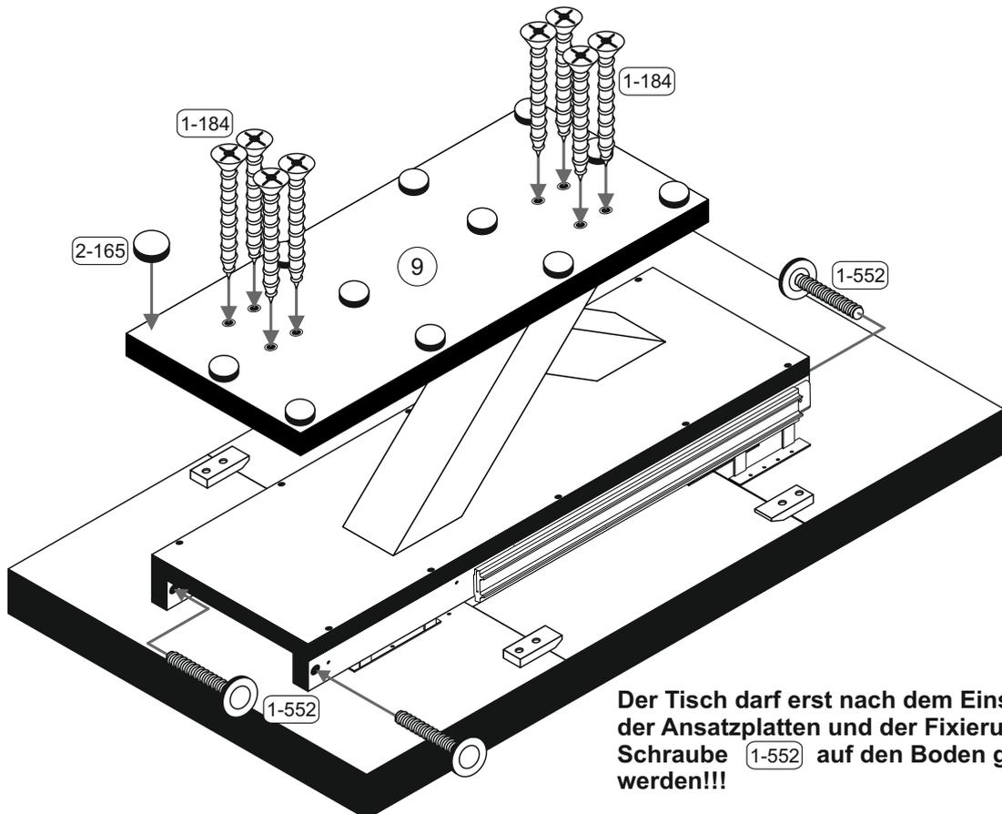
Der Tisch darf erst nach dem Einschieben der Ansatzplatten und der Fixierung mit der Schraube **1-552** auf den Boden gestellt werden!!!
