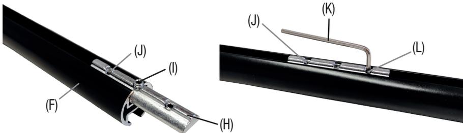
Möchten Sie einen Träger (siehe Schritt 3) genau bei der Profilstückelung setzen, kann der Nutstein (E) sowie die mittlere Schraube (I) am Profilverbinder (H) abgenommen werden (Nutstein und Schraube werden nicht mehr benötigt). Befestigen Sie nun die Schraube (D) durch den Träger (C) am mittleren Loch des Profilverbinders (H).
