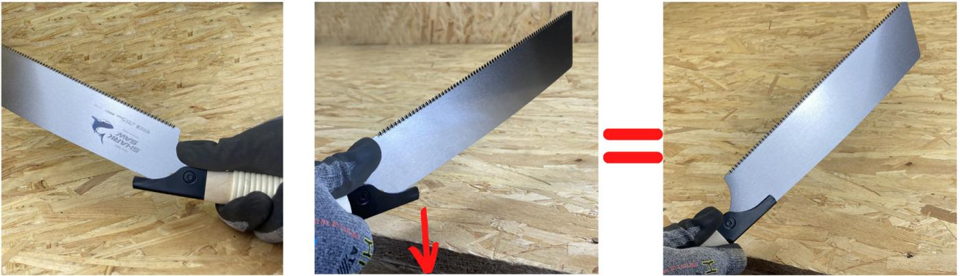
Das Austauschen und Wechseln von Sägeblättern ist für alle Sägetypen mit dieser Aufnahme identisch!
