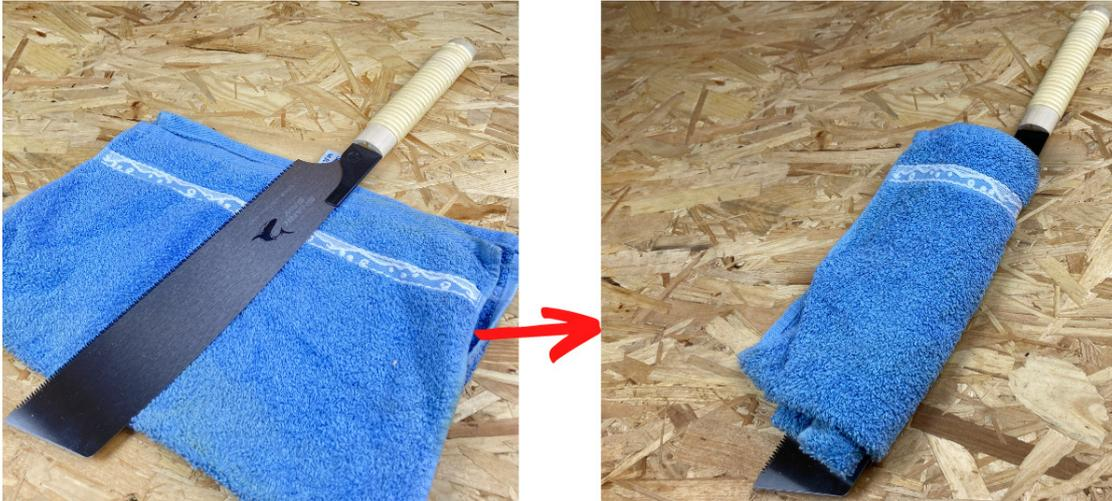
2) Das Sägeblatt ist fest in der Aufnahme des Griffes fixiert. Fassen Sie das Ende - des im Tuch eingewickelten - Sägeblattes an und schlagen Sie den Griff leicht auf das Holz. Wiederholen Sie den Vorgang bis sich das Sägeblatt aushakt. Wird das Sägeblatt um ca. 45% geschwenkt, lässt sich das Sägeblatt aus dem Griff aushaken.
