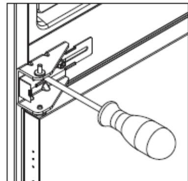
7. Den Stift vom oberen Scharnier lösen, das Scharnier um 180° drehen und den Stift wieder einsetzen
