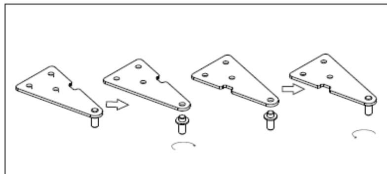
8. Den Stift des oberen Scharniers oben in das vorgebohrte Loch der Gerätetür stecken und alles auf der linken Seite anschrauben. Prüfen Sie, ob die Gerätetür horizontal und vertikal ausgerichtet ist und die Dichtungen gut schließen. Eventuell die Scharniere nachjustieren.
