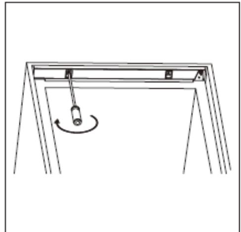
Die Gummidichtung zwischen dem Gerät und dem Einbauschränk an der Seite der Türöffnung befestigen
