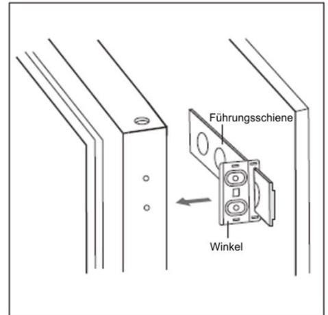
Kontrollieren Sie, ob sich die Tür gut öffnen und schließen lässt. Wenn nicht, die Türbefestigung nochmals einstellen. Die Halterung des Gerätes mit 2 langen Schrauben unten am Einbauschränk festschrauben.
