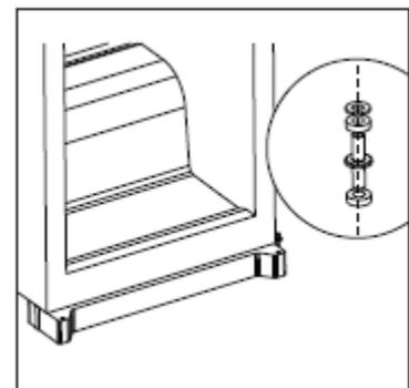
4. Nehmen Sie die untere Gerätetür und setzen Sie sie auf den unteren Stift. Die Gerätetür vorsichtig schließen und darauf achten, dass die Dichtungen gut schließen.
