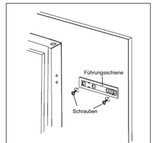
Wiederholen Sie die Einbauanweisungen für den Einbau der weiteren Führungsschienen.
