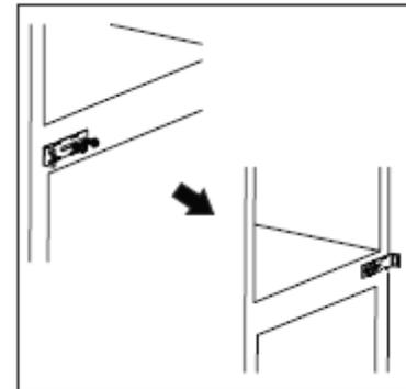
6. Den Stift vom mittleren Scharnier in das Loch am Scharnier stecken. Die obere Gerätetür nehmen und auf den Stift des mittleren Scharniers stecken. Die Gerätetür vorsichtig schließen. Darauf achten, dass sie horizontal und vertikal ausgerichtet ist und die Dichtungen gut schließen.
