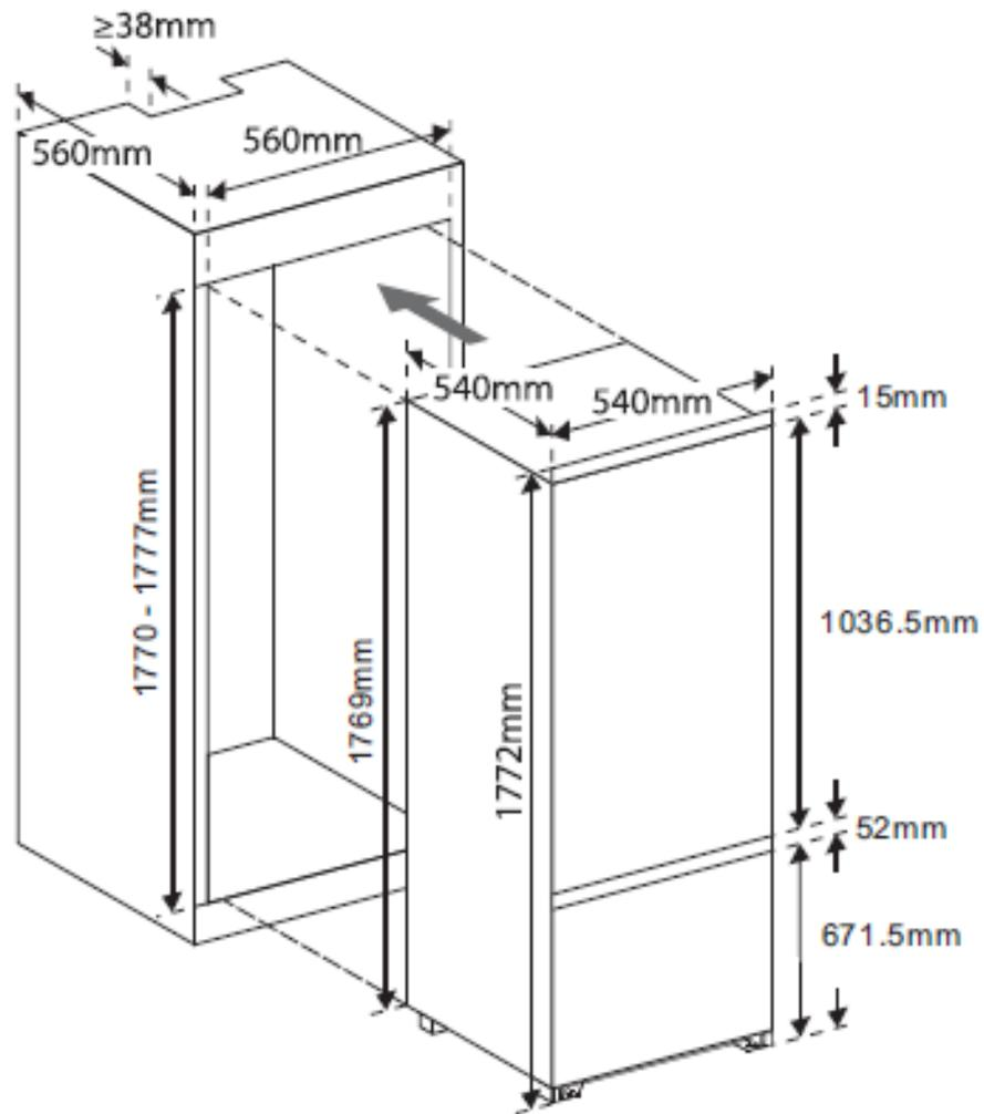
Für eine ausreichende Lüftung den Anweisungen in der Abbildung folgen. Der Einbauschränk muss über eine Zwangsbe- und -entlüftung verfügen.
