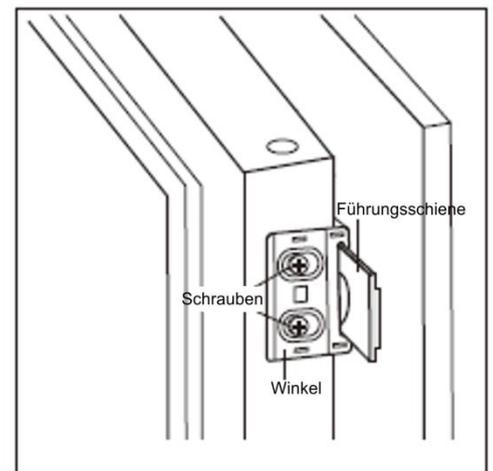
Öffnen Sie die Möbeltür zusammen mit der Gerätetür. Markieren Sie die Position der Schraublöcher der Führungsschiene so, dass sich die Tür gut schließen und öffnen lässt.
