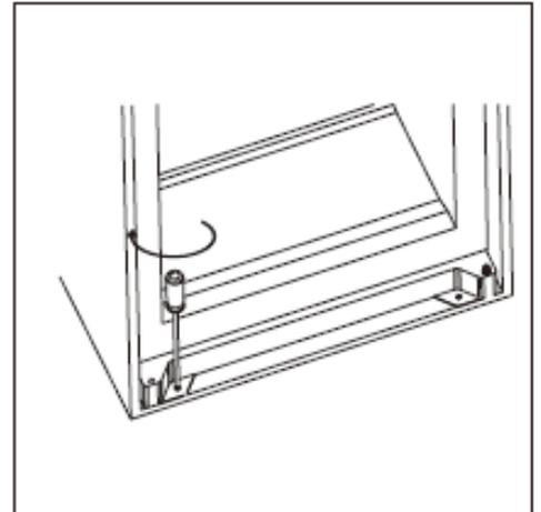
Die Halterung oben mit den kleinen Schrauben am Einbauschränk festschrauben.
