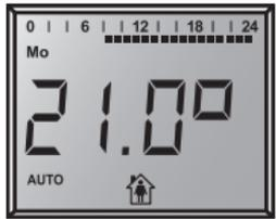
Das Thermostat wechselt im Automatikbetrieb entsprechend dem eingestellten Zeitprogramm zwischen zwei Temperaturen.
