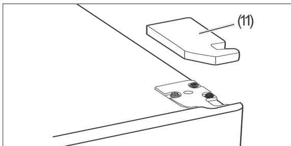
2. Hebeln Sie die Scharnierblende (11) mit Hilfe eines Schlitz-Schraubendrehers vorsichtig nach oben ab.
