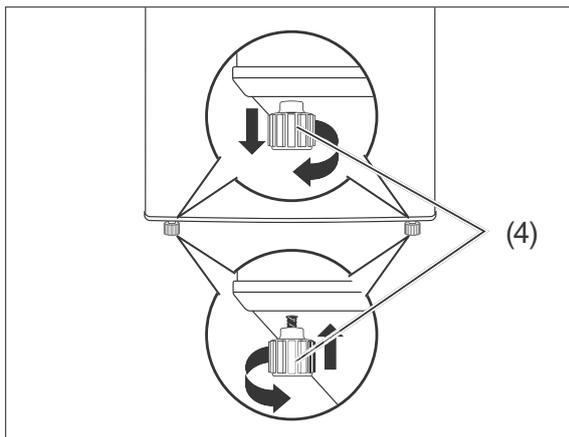
3. Gleichen Sie Unebenheiten des Untergrunds mithilfe der beiden vorderen Gerätefüße (4) aus.
