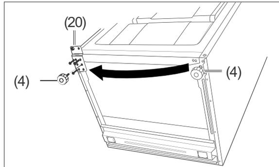
9. Schrauben Sie die Scharnierplatte (20) sowie die Stützplatte (26) auf der gegenüberliegenden Seite wieder an.
