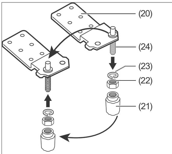
6. Schrauben Sie die Zierkappe (21) vom Scharnierbolzen (24).
