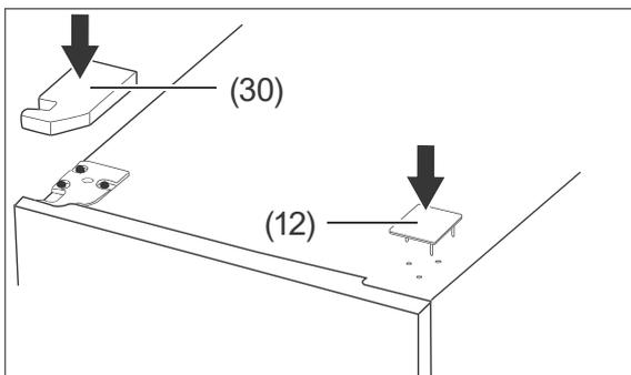
8. Pressen Sie die Scharnierblende (30) auf die Scharnierplatte und die Abdeckplatte (12) in die Löcher auf der gegenüberliegenden Seite.
