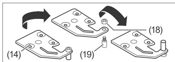
1. Schrauben Sie die Mutter (18) mit einem 10er Schraubenschlüssel vom Scharnierbolzen (19) ab. Schrauben Sie den Scharnierbolzen (19) von der Oberseite der Scharnierplatte (14) ab und schrauben Sie ihn auf der Unterseite wieder an. Schrauben Sie die Mutter wieder am Scharnierbolzen fest.
