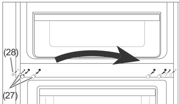
1. Entfernen Sie die 3 Blindstopfen (27) sowie die Zierkappe (28) auf der linken Seite aus dem Bereich des mittleren Scharniers, und befestigen Sie sie an den entsprechenden Stellen auf der gegenüberliegenden Seite.
