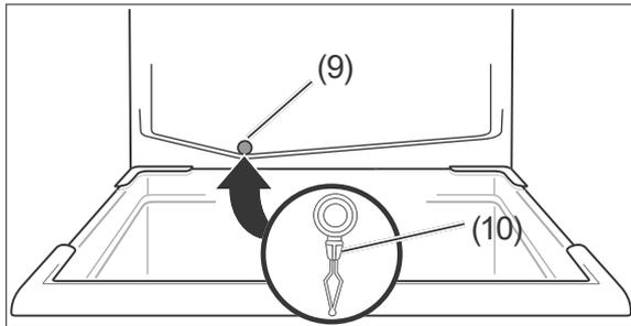
11. An der Rückwand des Kühlbereichs oberhalb der Gemüseschublade (6) befindet sich der Tauwasserablauf (9). In der Öffnung des Tauwasserablaufs steckt das Reinigungswerkzeug (10). Reinigen Sie damit den Tauwasserablauf.
