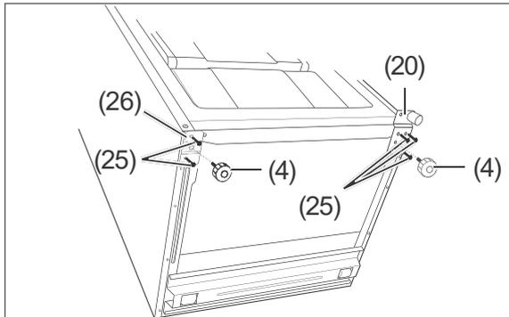
2. Kippen Sie das Gerät so weit nach hinten (45° max.), dass Sie die vorderen Gerätefüße (4) und die untere Scharnierplatte (20) gut erreichen können.
