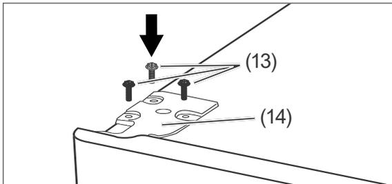
6. Stecken Sie die obere Scharnierplatte (14) auf die Kühlbereichstür, und schrauben Sie sie anschließend mit den drei Kreuzschlitzschrauben (13) fest.
