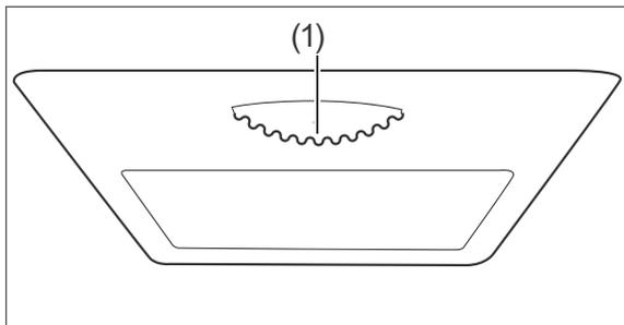
Mit dem Temperaturregler (1) schalten Sie das Gerät ein und aus. Er befindet sich an der Decke des Kühlbereichs.
