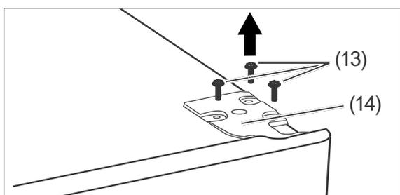
4. Lösen Sie die Schrauben (13), und entfernen Sie das obere Scharnier (14).
