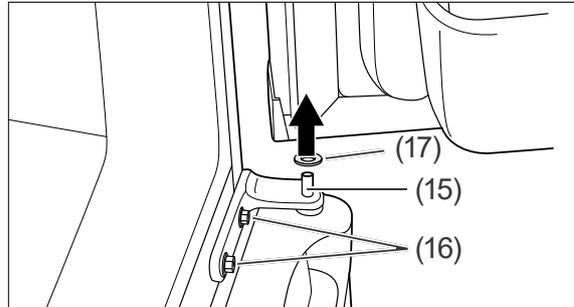
5. Öffnen Sie die Kühlbereichstür, und heben Sie sie senkrecht nach oben von dem Bolzen des mittleren Scharniers (15) ab. Stellen Sie die Tür beiseite.
