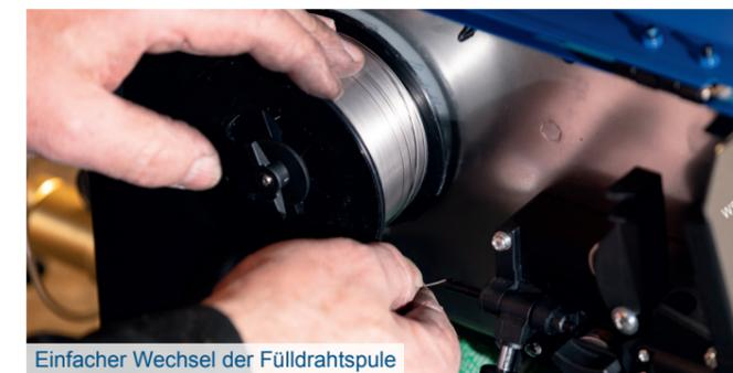
Einfacher Wechsel der Fülldrahtspule
