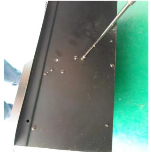
9: Schrauben an beiden Seiten entfernen.
