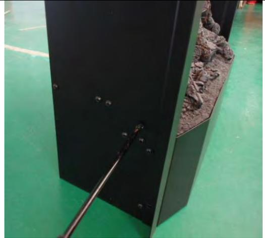
4: Wie gezeigt die Schrauben der Fixierungsleiste der Glasscheibe entfernen.
