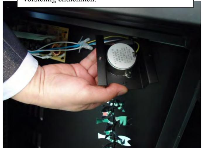
11 : Wie gezeigt Schrauben lösen und den Elektromotor entnehmen.
