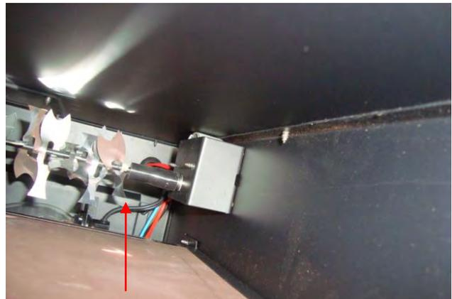
4- Überprüfen Sie, ob die Achse der Reflektoren richtig justiert ist (kann durch starke Vibrationen dejustiert sein). Falls nötig, kann eine Justage leicht per Hand vorgenommen werden.
