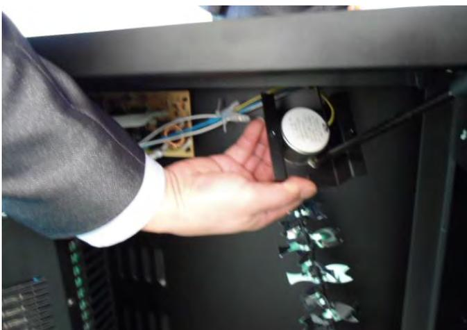
12: Neuen Elektromotor in die Abdeckung einsetzen und fixieren.
