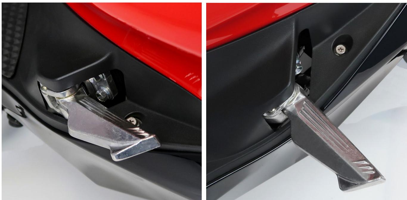
Für mehr Komfort sind klappbare Fußrasten für den Beifahrer verbaut.
