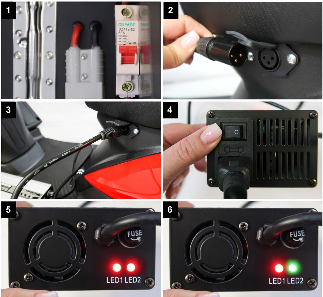
Laden Sie den MAXIMUS MX3-25 über die Ladebuchse, die sich seitlich unter der Sitzbank befindet.
