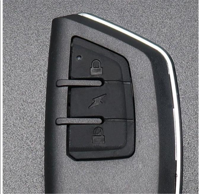
Mit der oberen Taste (**geschlossenes Schloss-Symbol**) schalten Sie die Alarmanlage ein. Sie hören einen Signalton.
