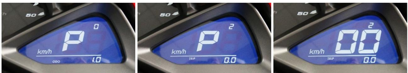
**D. Geschwindigkeitsstufe:** Hier sehen Sie die gewählte Geschwindigkeitsstufe.
