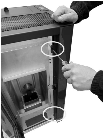
Fig. 25 - Die Schrauben entfernen
