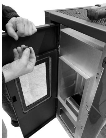
Fig. 23 - Das Scharnier abnehmen
