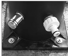
Ispusni otvor s čepom (lijevo) ulazna armatura s crijevnim priključkom (desno)
