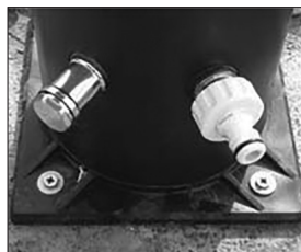
Tömningshål med propp (t.v.) slangkoppling vid inloppet (t.h.)
