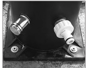
Ürítőnyílás dugóval (bal oldalon) bemenő oldali szerelvény tömlővéggel (jobb oldalon)
