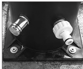
Сливное отверстие с пробкой (влево) входная арматура со шланговым наконечником (вправо)
