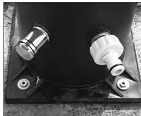
отвор за източване със запущалка (вляво) входна арматура накрайник за маркуч (вдясно)
