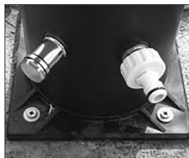
Izpustna odprtina s čepom (levo) dovodna armatura s cevnim zaključkom (desno)
