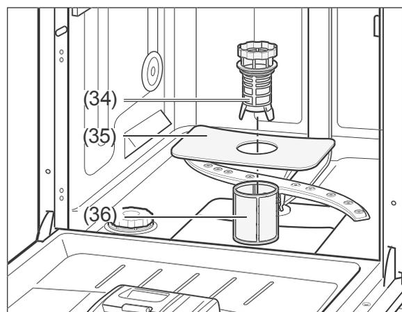
Überprüfen Sie nach jedem Spülgang das Grobsieb (34), das Hauptsieb (35) und das Feinsieb (36), und entfernen Sie ggf. Speisereste und Fremdkörper:
