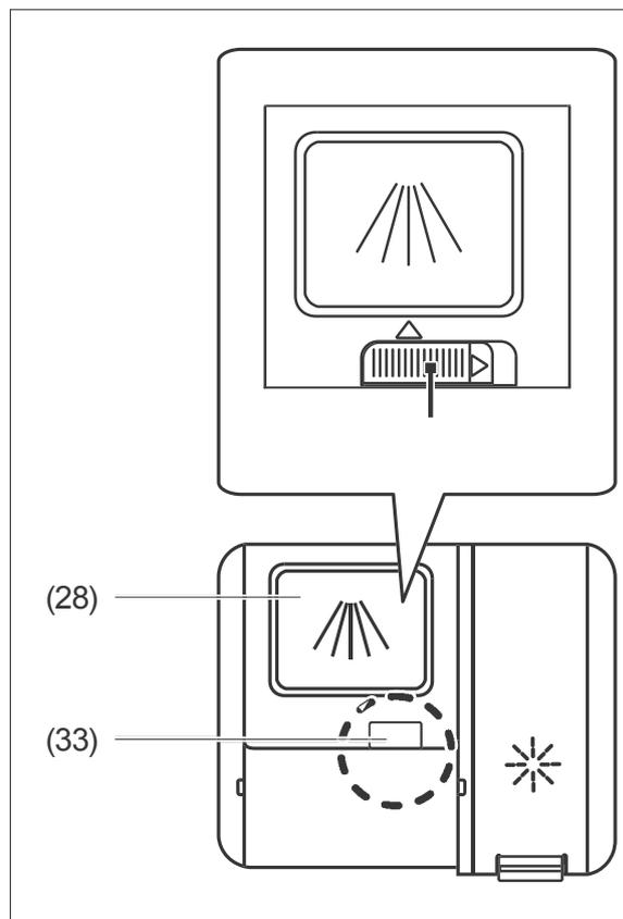
1. Schieben Sie den Verschluss (33) der Spülmittelkammer (28) zur Seite. Der Deckel springt auf.
