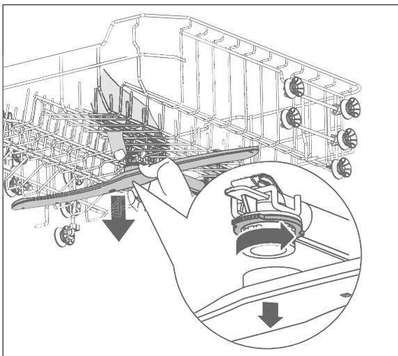
3. Der obere Sprüharm ist mit einem Bajonett-Verschluss befestigt. Halten Sie die beiden gezackten Bajonettgriffe fest, drehen Sie sie im Uhrzeigersinn und nehmen Sie den Sprüharm ab.
