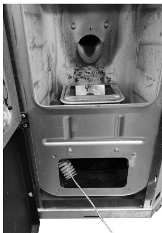
Fig. 74 - Mit einer Rohrreinigungsbürste reinigen
