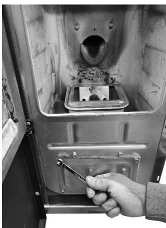
Fig. 72 - Die Schrauben entfernen
