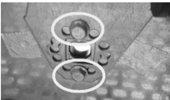
Fig. 81 - Die Schrauben entfernen
