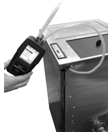
Fig. 70 - Anschluss des Digitaldruckwächters
