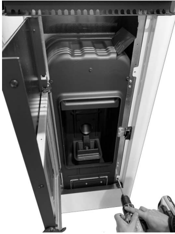
Fig. 33 - Vordere Schrauben entfernen
