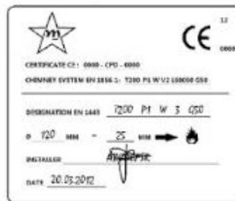
Fig. 4 - Beispiel für Typenschild
