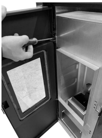
Fig. 22 - Die Schrauben abnehmen
