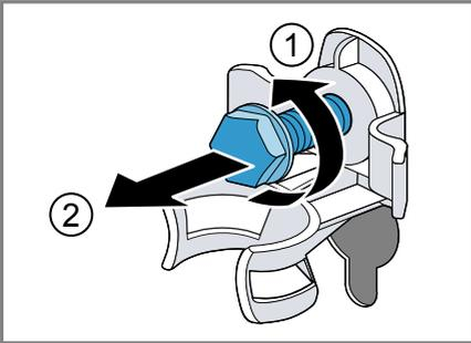
3. Die Netzanschlussleitung aus der Halterung ziehen.
