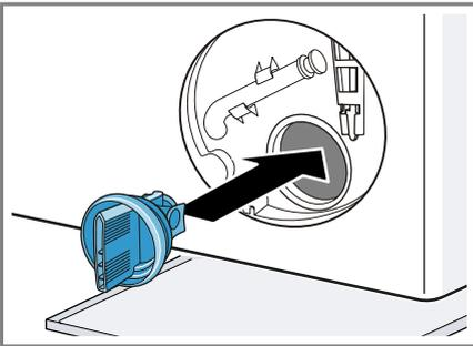
Sicherstellen, dass die Bauteile des Pumpendeckels fest zusammensetzen.
