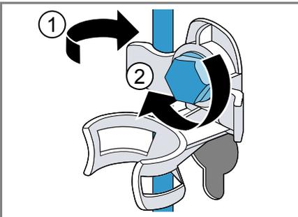
5. Den Schlauch in die Halterung einsetzen.
