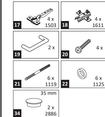
De begeleidende wandmontage hardware (pluggen en schroeven) is alleen geschikt voor massief metselwerk (bijvoorbeeld beton of bakstenen muren). Voor andere muur structuren zijn eventueel bijzondere ankerbouten en andere noodzakelijke. Draai indien nodig, een deskundige.
